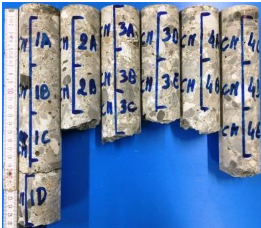
Vue d'ensemble des carottes prélevées avec implantation des éprouvettes
