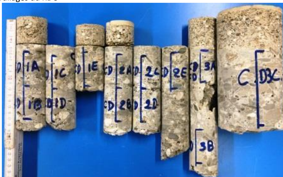
Vue d'ensemble des carottes prélevées avec implantation des éprouvettes
