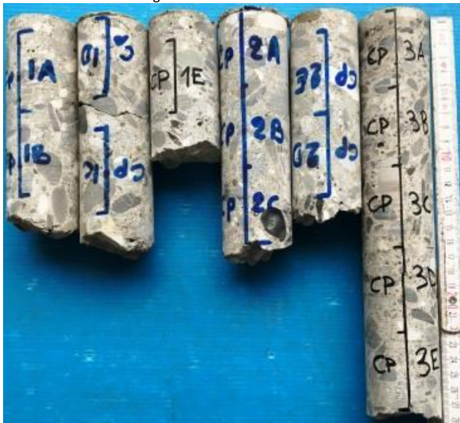
Vue d'ensemble des carottes prélevées avec implantation des éprouvettes
